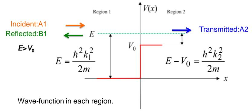
$$\psi(x) = \begin{cases} \underline{A^{(1)}} e^{ik_1 x} + \underline{B^{(1)}} e^{-ik_1 x} = \psi_1(x), & k_1 = \sqrt{\frac{2mE}{\hbar^2}} \\ \underline{A^{(2)}} e^{ik_2 x} = \psi_2(x), & k_2 = \sqrt{\frac{2m(E - V_0)}{\hbar^2}} \end{cases}$$
